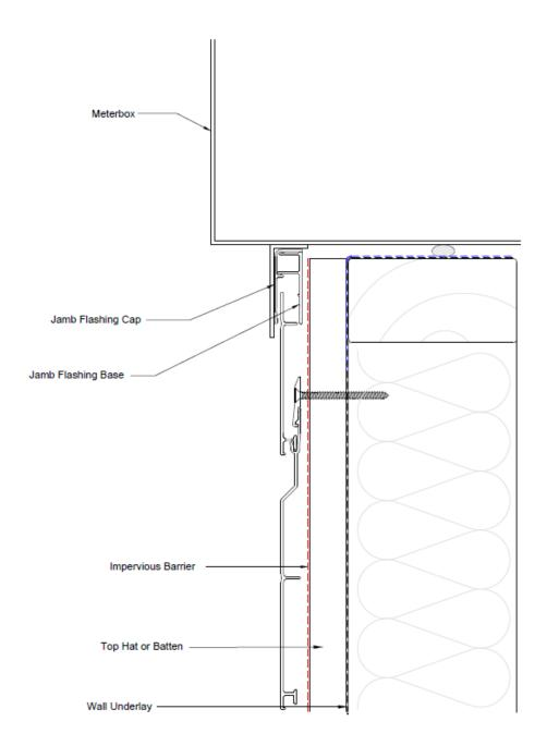
**Horizontal Cladding - Meter Box Sill Detail**
